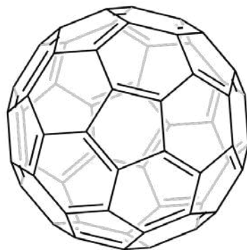
Рис. 1.3. Структура молекули C_{60}
